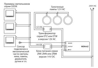
Управление в секвенции **вкл./ выкл.**: очередные короткие прикосновения к проводящей части, подключенной к датчику.
