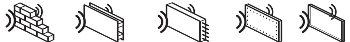
Ziegelsteine 10 % bis 40 %, Holz und Gipskarton 5 % bis 20 %, Stahlbeton 40 % bis 80 %, Metall 90 % bis 100 %, Glas 10 % bis 20 %
