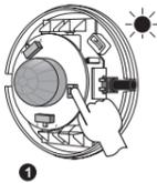
Drücken Sie die Taste PROG am RCR-01 und lassen Sie diese dann los. Rote LED wird unter der Linse eingeschaltet (konstantes Signal).
