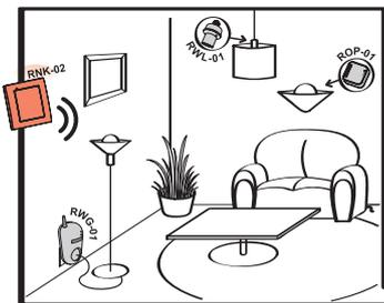
Der Funksender mit Taste RNK-02 steuert den Funk-Lichtschalter RWL-01 (Einschalten/Ausschalten), den Funkempfänger ROP-01 (Einschalten/Ausschalten) oder den Fernsteuerungsanschluss RWG-01 (Einschalten/Ausschalten).
