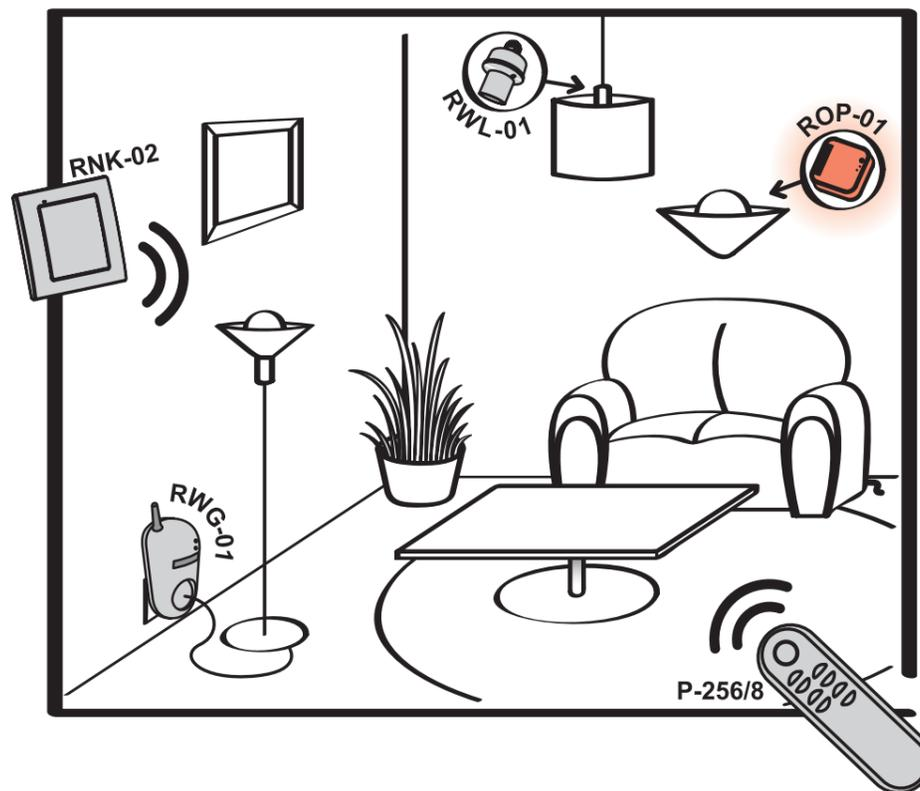
Der 1-Kanal-Funkempfänger ROP-01 ist ein Empfänger der 8-Kanal-Fernsteuerung P-256/8 und des 2-Kanal-Funksenders mit Taste RNK-02 (Einschalten/Ausschalten von Lichtquellen). Die vorstehenden Sender können auch den Funk-Lichtschalter RWL-01 und den Fernsteuerungsanschluss RWG-01 steuern.
