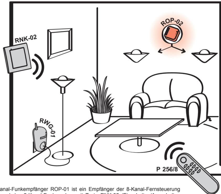
Der 2-Kanal-Funkempfänger ROP-01 ist ein Empfänger der 8-Kanal-Fernsteuerung P-256/8 und des 2-Kanal-Funksenders mit Taste RNK-02 (Einschalten/Ausschalten von Lichtquellen). Die vorstehenden Sender können auch den Fernsteuerungsanschluss RWG-01 steuern.
