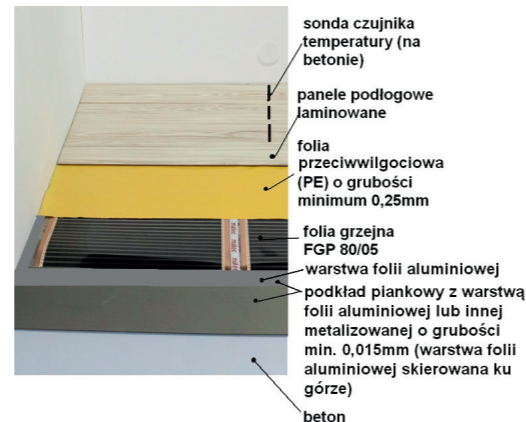
Rys. 3. Warstwy posadzki z zastosowaniem folii grzejnej.
