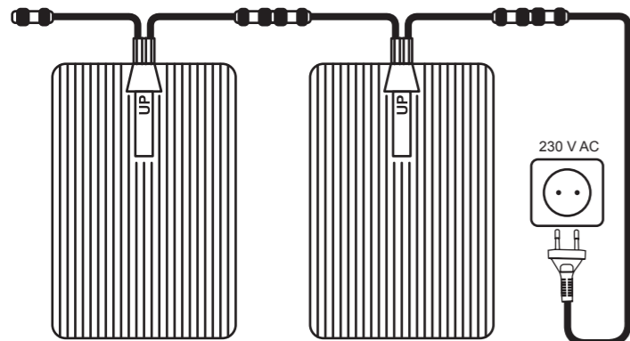
Rys 3. Podłączenie połączonych mat GMG do zasilania
