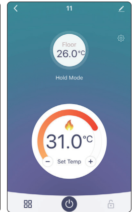
Ekran sterowania w trybie utrzymywania temperatury
