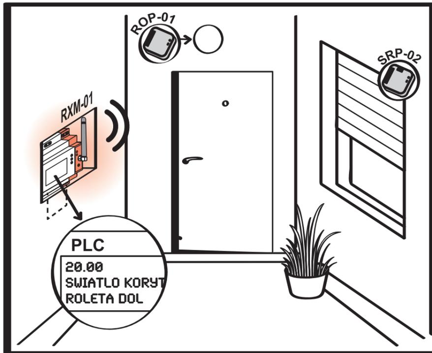
Преобразователь RS485/EXTA FREE RXM-01 предоставляющий возможность переноса управляющих сигналов с контроллера PLC, установленного в распределительном щите, на беспроводные устройства системы управления EXTA FREE (встраиваемый радиоприемник ROP-01, встраиваемый контроллер рольставней SRP-02).
