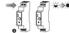
Ввести в устройство RXM-01 код нажатия кнопки 1. Зажжется (сначала мигающий, потом постоянный сигнал) красный диод LED устройства ROM-01.
