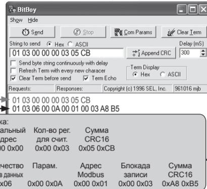
**Примечание:** Для изменения параметров передачи следует, в первую очередь, удалить соответствующий бит блока записи конфигурационных регистров. После изменения содержания конфигурационных регистров, параметры передачи будут актуализованы после отправления ответа (в широковещательном режиме устройство не высылает ответ).
