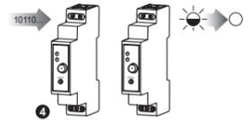
Ввести в устройство RXM-01 код отпускания кнопки 1. Диод LED устройства ROM-01 загорится (мигающий сигнал), а потом потухнет – ПЕРЕДАТЧИК ЗАПИСАН.
