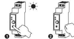
Нажать кнопку PROG устройства ROM-01 и удерживать ее до зажигания (постоянный сигнал) красного диода LED. После отпустить кнопку PROG.
