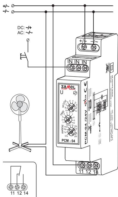
**Внимание!** Импульс, который заставит устройство работать может быть импульсом снаружи (из зажима L, N, + или -). Изменение режима работы (в любом моменте) будет причиной немедленного начала нового режима работы. Изменения установки диапазона времени производятся сразу же.
